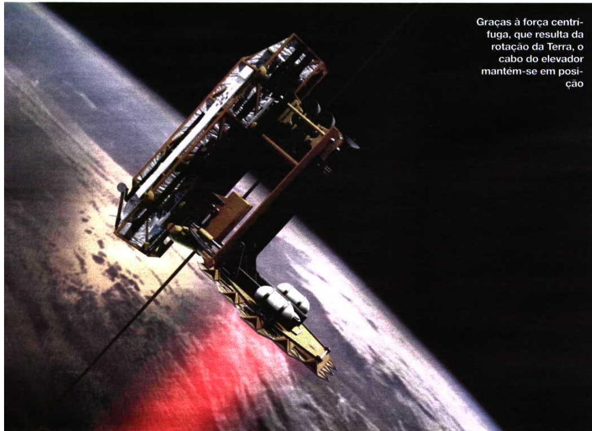
Graças à força centrífuga, que resulta da rotação da Terra, o cabo do elevador mantém-se em posição
